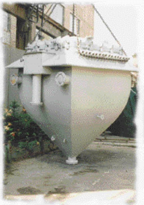
Згущення осаду соків першої та другої сaturaції, а також фільтрування клеровок цукру-сирцю сиропів цукрового виробництва
